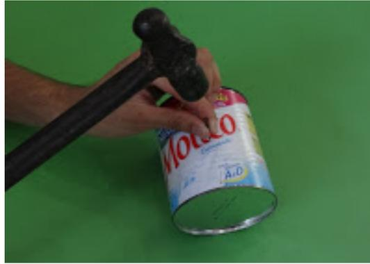
Figura 6: Ilustração de furo com prego na lata<sup>52</sup>.
